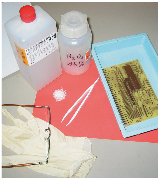
Figura 3. Material necessário para a remoção do cobre.
