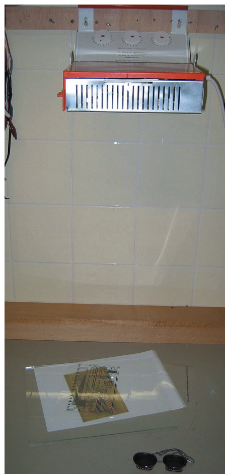
Figura 2. Exposição de uma placa com um aparelho de bronzear.
